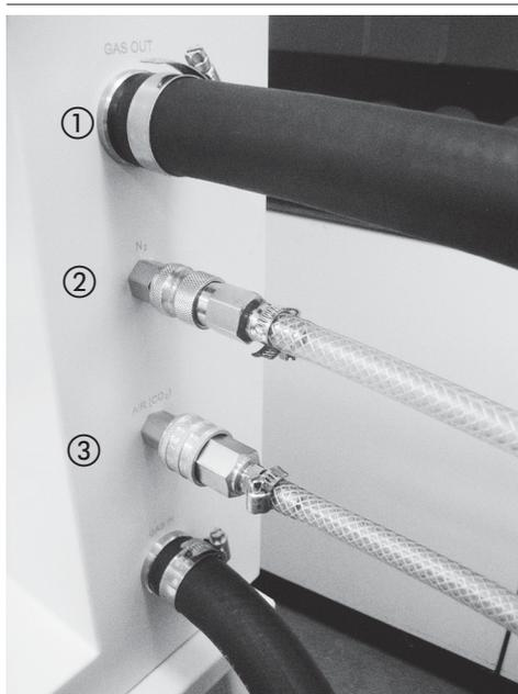
La connexion pour le gaz sécheur est située sur le côté droit de l'instrument (voir section 4.10 pour plus de détails). Elle est réalisée au moyen de tuyaux Polypress et Solaflex en combinaison avec des colliers et des raccords rapides. Le type de connexion dépend de la prise et du gaz transporté. Le gaz sortant est recyclé par une Boucle d'inertage B-295/un Déshumidificateur B-296. En circuit fermé, l'Aspirateur agit comme une pompe de circulation pour générer un flux de gaz constant.
