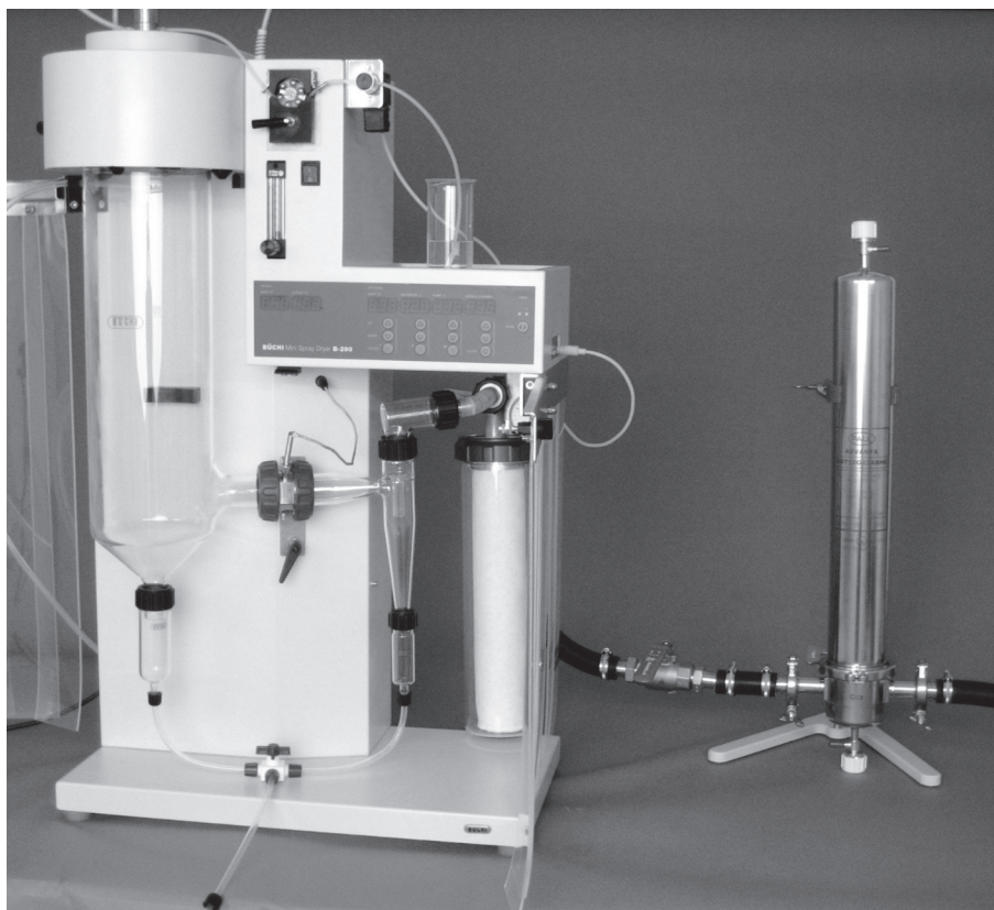
Figura 5.11: Filtro pulente installato con rubinetto di arresto
