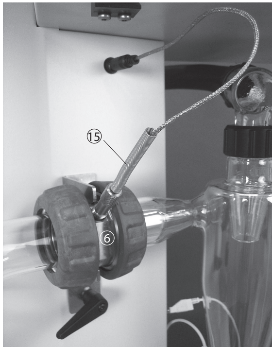
Figura 5.2: Installazione delle componenti in vetro
