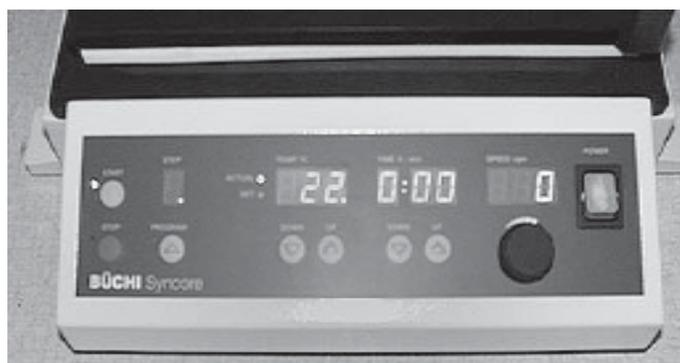
Illustration 8: Écrans de la console de commande après le démarrage de l'appareil
