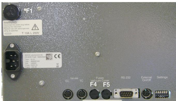
Illustration 17: Sorties des signaux et fusibles avec le numéro de commande correspondant (qty 10) pour la nouvelle configuration de Syncore.
