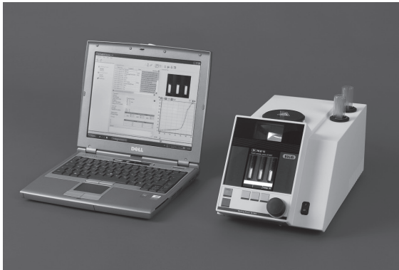
Abb. 5.1: Verbinden eines Schmelzpunkt M-565 mit der MeltingPoint Monitor Software
