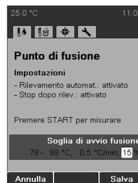
Soglia: il valore è necessario per la determinazione dell'intervallo di fusione. Il valore default è fissato su 15% in quanto può essere utilizzato con l'80% delle sostanze.
