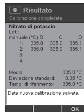
Al termine della calibrazione, lo strumento salva automaticamente la data dell'ultima calibrazione.
