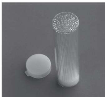
Figura 6.1: Capillari per la determinazione del punto di fusione
