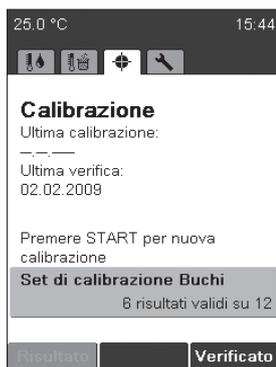
Lo strumento si riscalda automaticamente fino alla temperatura iniziale della prima sostanza. Nel contempo prepara almeno sei campioni della detta sostanza. Per la procedura, vedi il capitolo 6.2.1
