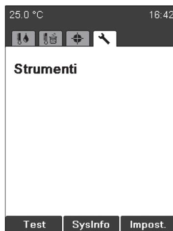
**Test:** controllo delle funzioni dello strumento. Per effettuare il controllo delle diverse funzioni seguire attentamente le istruzioni sullo schermo. Se il controllo delle funzioni indica NOT OK, contattare il servizio di assistenza. Il protocollo di test è descritta nella sezione 6.5.1.
