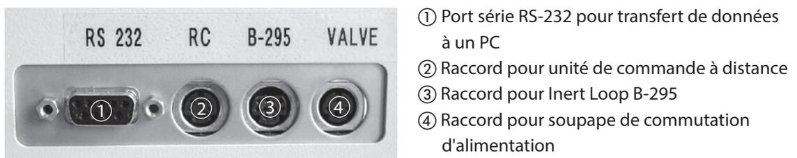
Fig. 4.6 : Raccords sur la face arrière de l'atomiseur de séchage B-290
