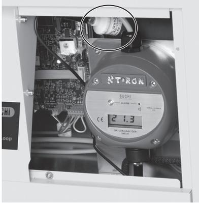
Fig. 7.3 : Remplacement du capteur d'oxygène
