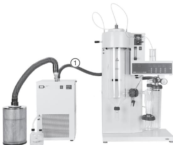
Fig. 5.24 : Tuyau entre l'atomiseur de séchage B-290 et le déshumidificateur B-296
