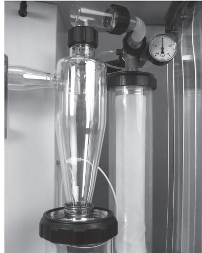
Fig. 5.6 : Installation du filtre de sortie
