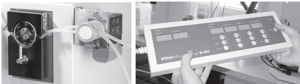
Fig. 4.7 : Soupape de commutation d'alimentation et unité de commande à distance
