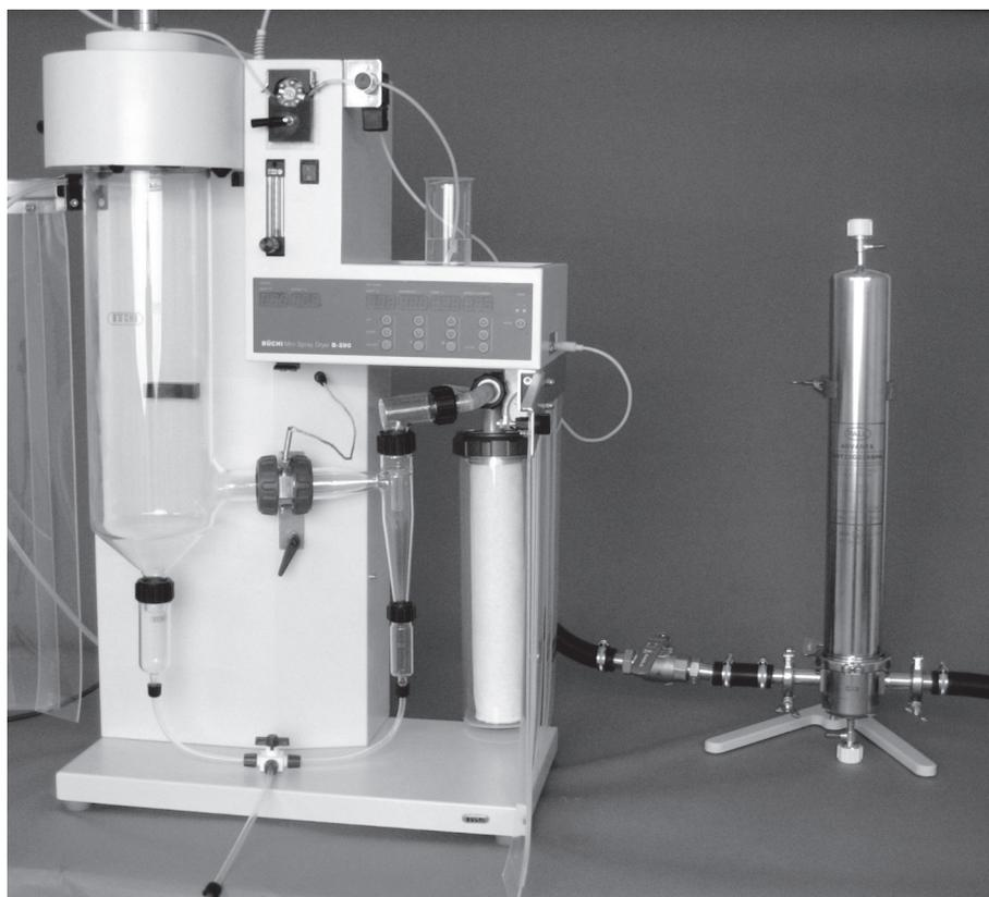
Fig. 5.11 : Filtre de nettoyage installé avec un robinet d'arrêt
