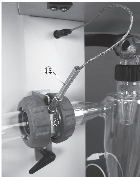
Fig. 5.2 : Installation des pièces en verre
