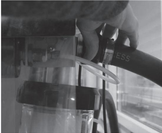
Déconnecter le tube Polypress des pièces en verre et du chauffage.
