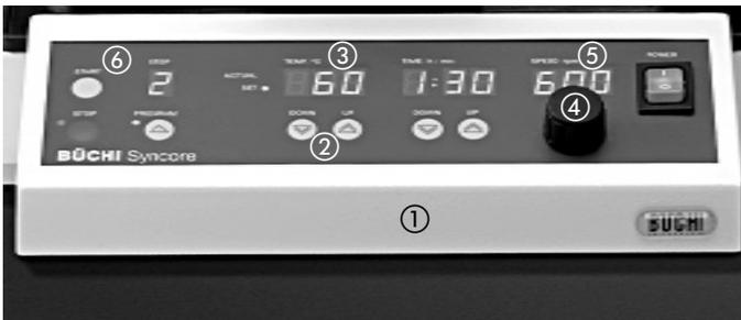
Bild 13: Display der Grundeinheit nach Aufstarten des Gerätes
