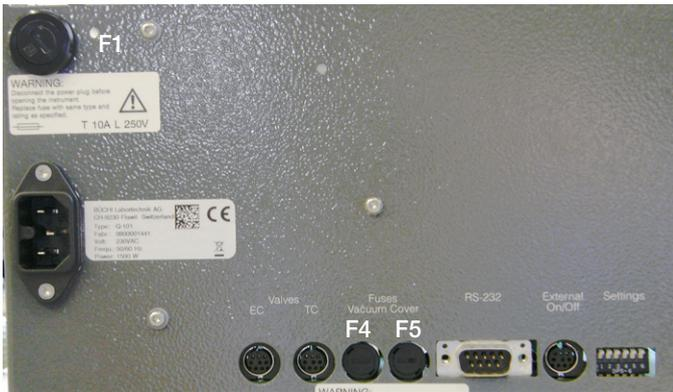
Bild 17: Signal-Ausgänge und Sicherungen mit entsprechender Bestellnummer (qty 10) für die neue Syncore-Konfiguration.
