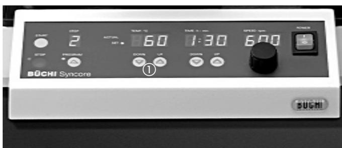
Bild 15: Vakuumschluss Solltemperatur Display
