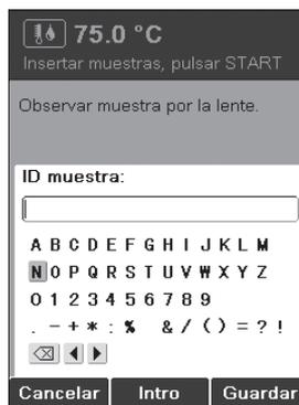
El instrumento pide que identifique la muestra durante el precalentamiento (para más detalles sobre cómo introducir el texto véase 6.1.3). Esta solicitud se puede desactivar modificando la configuración «Petición de ID de muestras» (véase 6.5).
