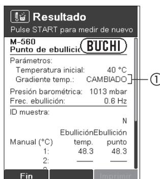
Si el gradiente de temperatura se modifica durante la medición, en el resultado aparece CAMBIADO (1) para el gradiente de temperatura.
