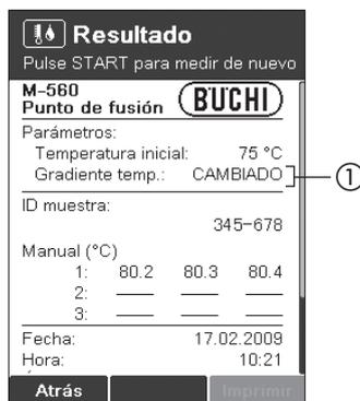
Si el gradiente de temperatura se modifica durante la medición, en el resultado aparece CAMBIADO (①) para el gradiente de temperatura.
