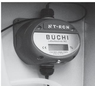
Nel modello “Advanced” è compreso un sensore di ossigeno, che viene utilizzato per monitorare la percentuale di ossigeno nel gas di essiccazione in modalità a 'Ciclo chiuso'.
