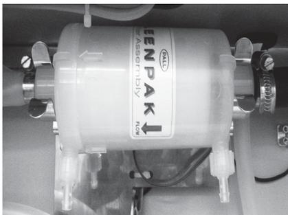
Il filtro in uscita recupera le particelle più piccole in modo che non possano essere rilasciate nell'ambiente.
