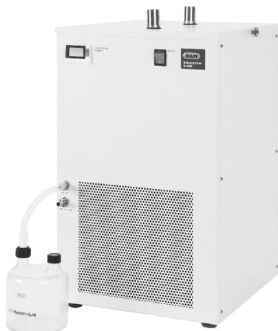
Il Deumidificatore B-296 Nano è un accessorio in grado di essiccare i gas in condizioni di umidità costanti e riproducibili a una temperatura di condensazione da 3 a 5°C. L'umidità si condensa mentre passa attraverso il refrigeratore del Deumidificatore B-296 Nano e viene quindi raccolta in un flacone chiuso.
