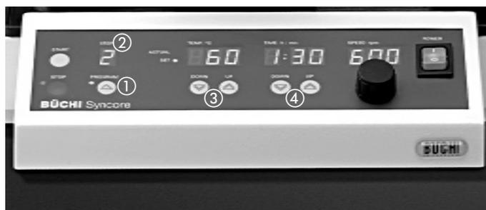
Figura 14: Pantalla de la unidad básica tras poner en marcha el aparato
