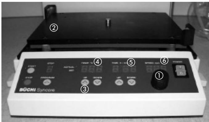
Figura 9: Mando de las funciones básicas a través de la consola de mando
