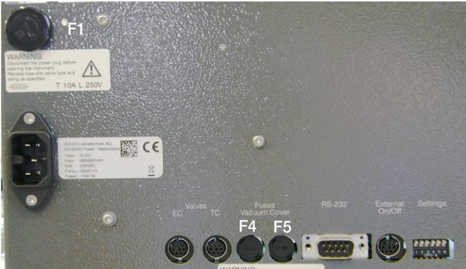
Figura 17: Salidas de señales y fusibles con número de pedido correspondiente (qty 10) para la nueva configuración Syncore
