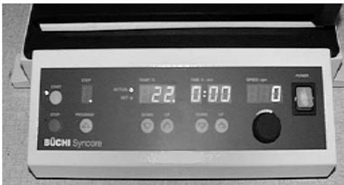
Figura 8: Displays de la consola de mando después de iniciar el aparato
