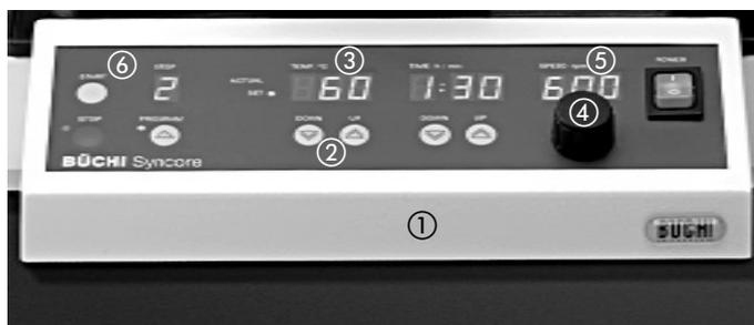
Figura 13: Pantalla de la unidad básica tras poner en marcha el aparato
