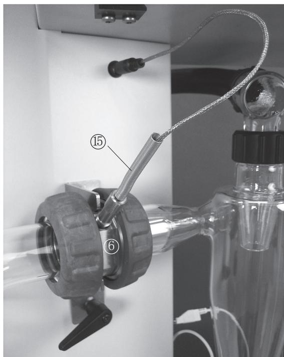
图 5.2: 安装玻璃组件
