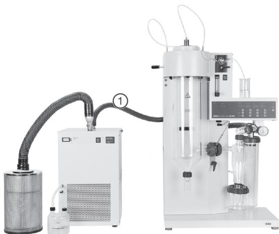
图 5.23: 小型喷雾干燥仪 B-290 和除湿器 B-296 之间的管道
