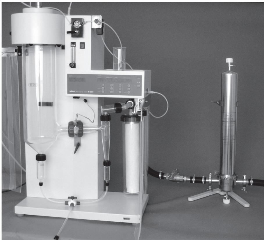
图 5.11: 装有旋塞阀的清洁过滤器
