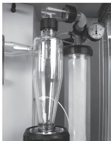
图 5.6: 安装出口过滤器
