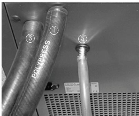
图 5.20: 闭环模式下小型喷雾干燥仪 B-290 高级版和惰性循环装置 B-295 管道安装
