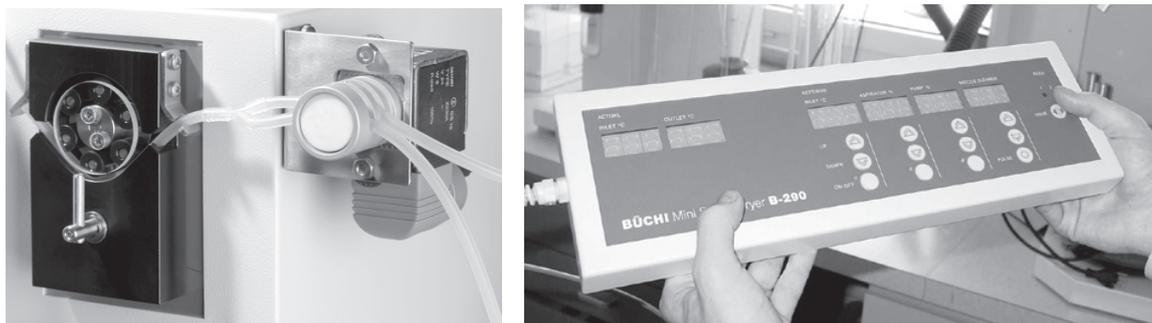
图 4.7: 输送样品切换阀和远程控制板
