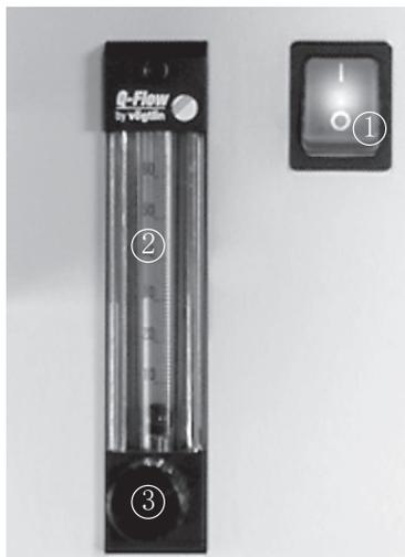
图 6.1: 开关、流量计和阀门
