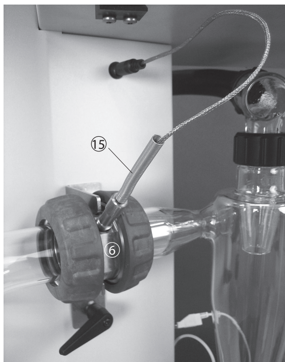
Fig. 5.2: Instalación del montaje de vidrio
