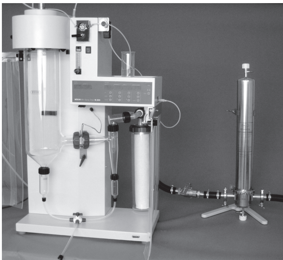
Fig. 5.11: Filtro de limpieza instalado con llave de paso
