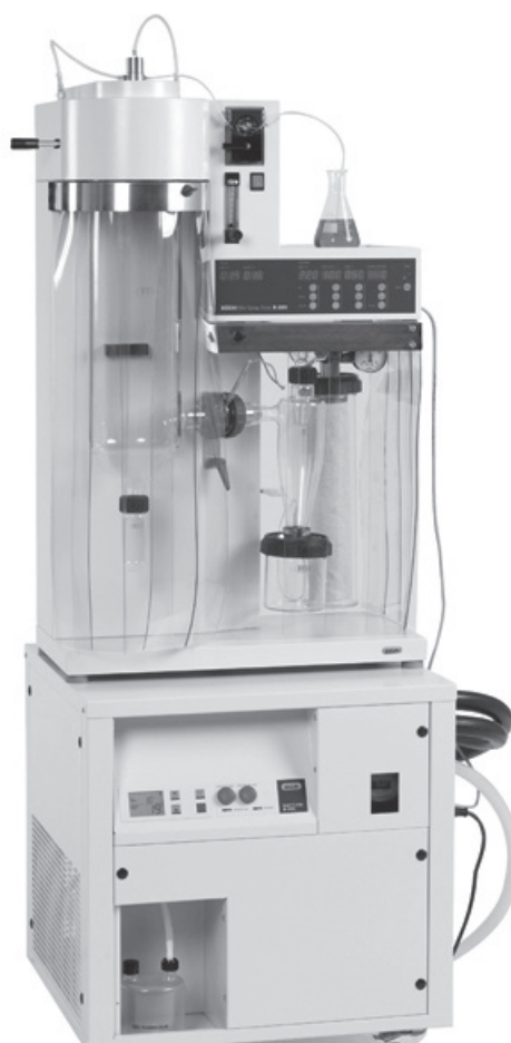
Fig. 5.19: Mini Spray Dryer B-290 Advanced con Loop Inerte B-295 como mesa con ruedas
