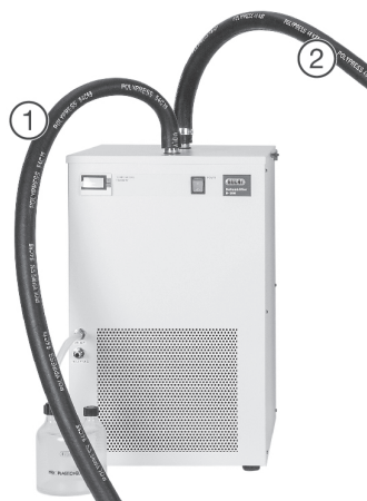
Fig. 5.25: Tubos entre el intercambiador de calor y el Mini Spray Dryer B-290
