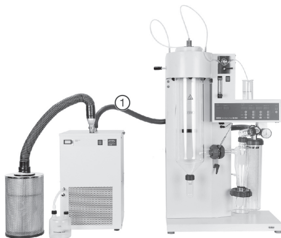
Fig. 5.24: Tubos entre el Mini Spray Dryer B-290 y el Deshumidificador B-296
