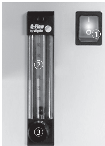
Fig. 6.1: Conmutador, medidor de flujo y válvula
