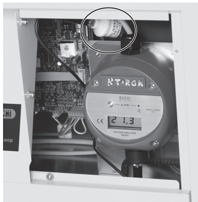
Fig. 7.3: Sustitución del sensor de oxígeno
