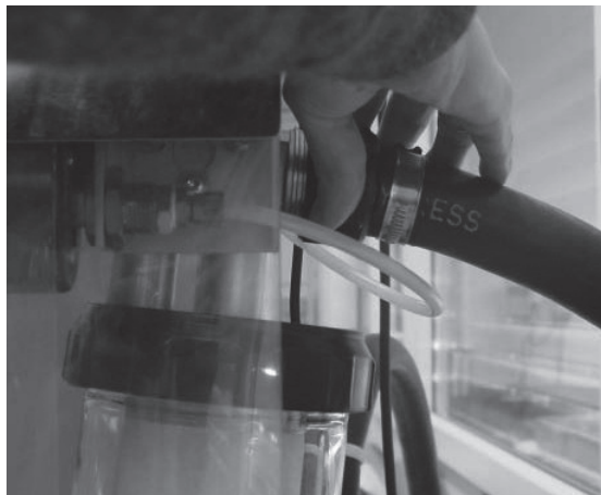
Fig. 7.1: Desconexión del tubo polypress
