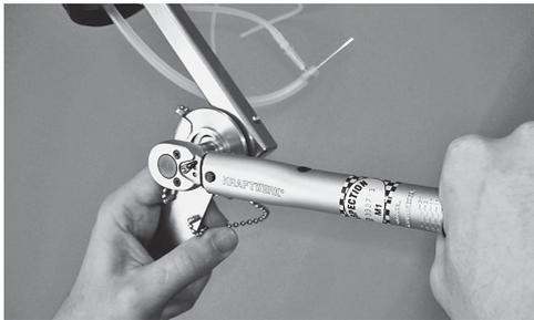
10. Zur Anbringung der Sprühkappe Montagewerkzeug a und BÜCHI-Drehmomentschlüssel b verwenden.
