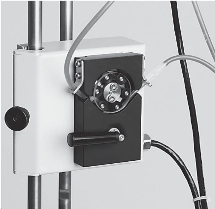
Beispielabbildung mit angebrachtem Produktschlauch und Adapterstück (transparenter Adapter am Pumpeneingang rechts).
