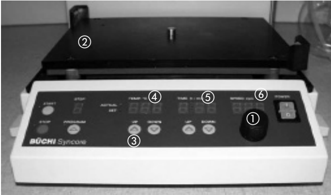
Figura 9: Comando delle funzioni fondamentali sul quadro di comando
