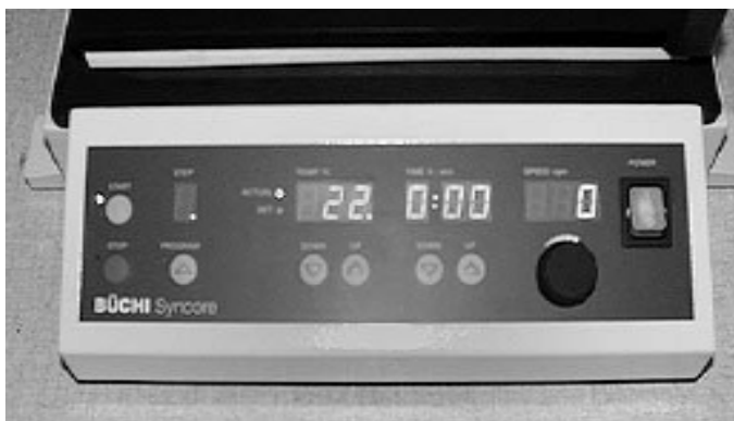
Figura 8: Display del quadro di comando dopo l'avviamento dell'apparecchio
