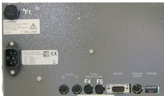
Figura 17: Uscite di segnale e fusibili col numero ordine corrispondente (qty 10) per la nuova configurazione Syncore.
