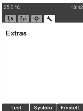
**Test:** Funktionsprüfung des Geräts. Zum Testen verschiedener Gerätefunktionen den Anweisungen in der Anzeige sorgfältig folgen. Wenn bei dem Test Fehler festgestellt werden, bitte Kundendienst kontaktieren. Das Testprotokoll wird in Abschnitt 6.5.1 beschrieben.
