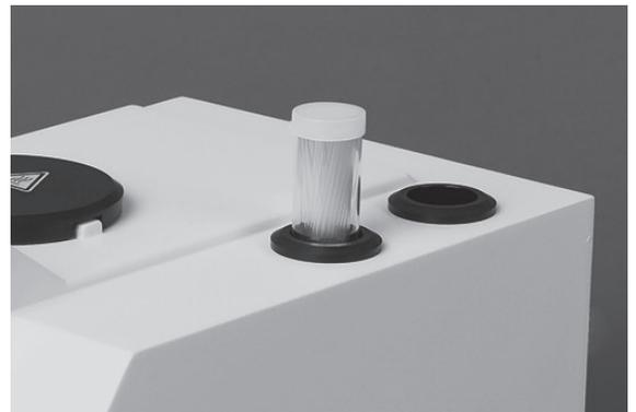
• Schmelzpunkt-Kapillaren in die Gehäuseöffnung stecken. Die zweite Öffnung dient zur Aufnahme gebrauchter Kapillaren.
