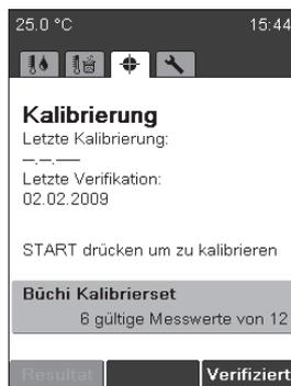
Das Gerät heizt automatisch auf die Starttemperatur der ersten Substanz auf. Bereiten Sie in der Zwischenzeit mindestens 6 Proben der entsprechenden Substanz vor. Zur Probenvorbereitung siehe Abschnitt 6.2.1.
