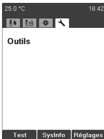
Test: contrôle de fonctionnement de l'instrument. Pour tester différentes fonctions, suivre attentivement les instructions affichées. Si un dysfonctionnement est signalé avec le texte «Non VALIDE», contacter le service après-vente. La procédure Test est décrite dans la section 6.5.1.
