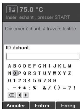
L'instrument exige un ID échantillon pendant le pré-chauffage (pour plus de détails sur la saisie de texte, voir la section 6.1.3). On peut désactiver cette requête en changeant le réglage du paramètre «Demande ID échant.» (voir la section 6.5).
