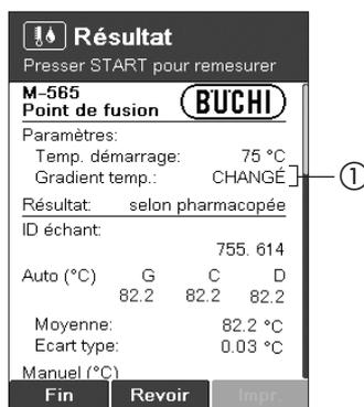
Si le gradient de température est modifié pendant une mesure, le résultat le signale avec l'indication CHANGÉ (①).
