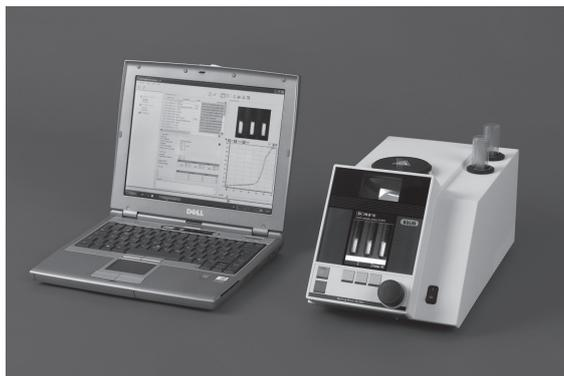
On peut commander le système Point de fusion M-565 avec le logiciel MeltingPoint Monitor. Dans ce cas, raccorder l'instrument à l'ordinateur de bureau ou portable avec un câble USB. Pour plus d'informations, consulter le guide d'installation sur le CD du logiciel.
