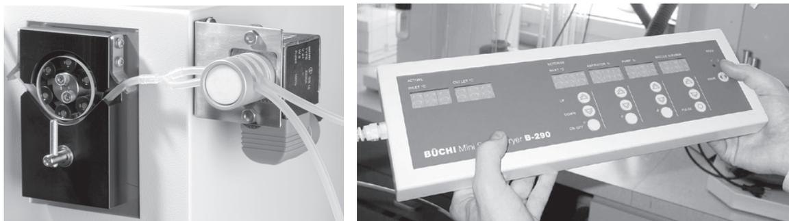
図 4.7：フィード切替えバルブとリモートコントロールパネル
