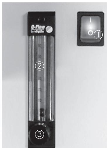
図 6.1：スイッチ、流量計、バルブ
