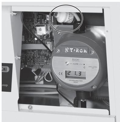
図 7.3：酸素センサーの交換
