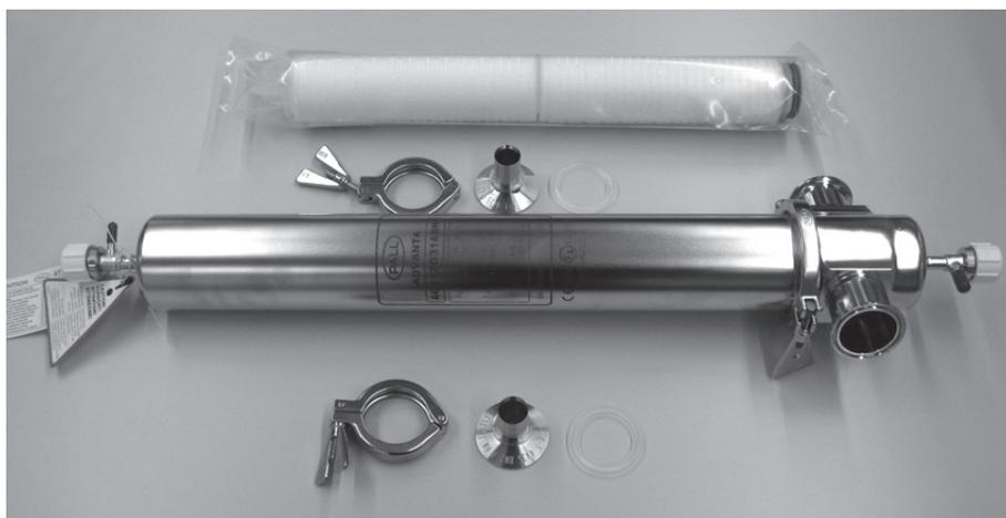
図 5.10：ハウジングとフィルターカートリッジ
