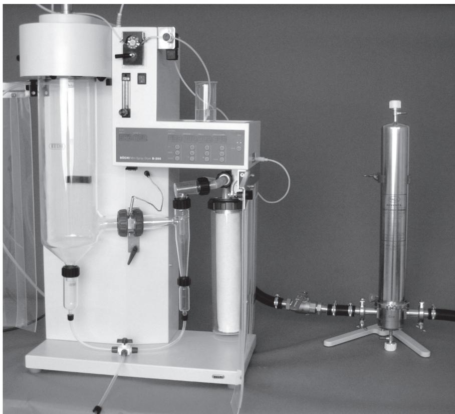
図 5.11：コックを取り付けたクリーニングフィルター
