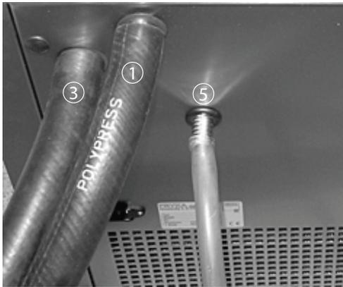
Abb. 5.21: Schlauchanschlüsse am Inert Loop B-295
