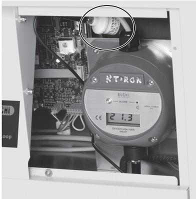
Abb. 7.3: Austauschen des Sauerstoffsensors
