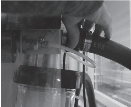
Den „Polypressschlauch“ vom Glasaufbau bzw. der Heizung abnehmen.
