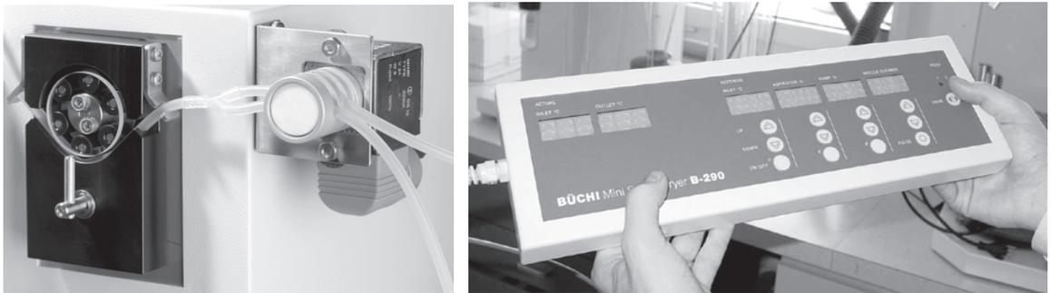
Abb. 4.7: Umschaltventil Ausgangslösung und Fernbedienung
