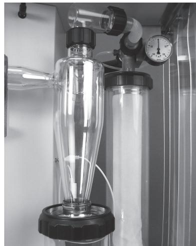
Abb. 5.6: Installieren des Ausgangsfilters
