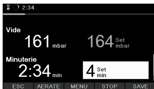
Fig. 34: Édition des paramètres au cours d'une distillation
