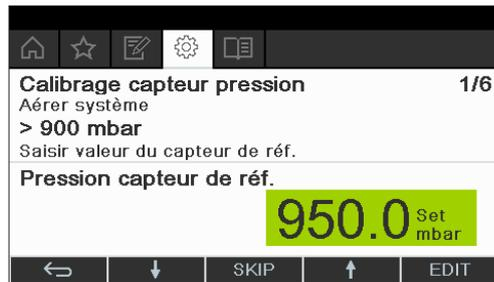
Fig. 58: Point de menu "Calibrage capteur pression"
