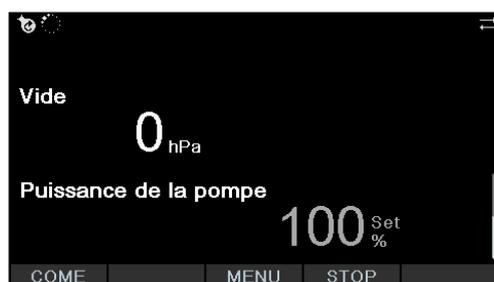
Fig. 39: Activation du mode continu pour le séchage du système
