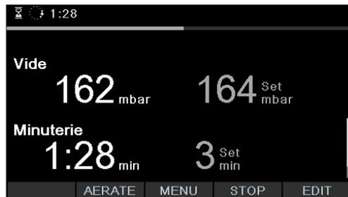
Fig. 33: Sous-menu "Minuterie" au cours d'un processus de distillation
