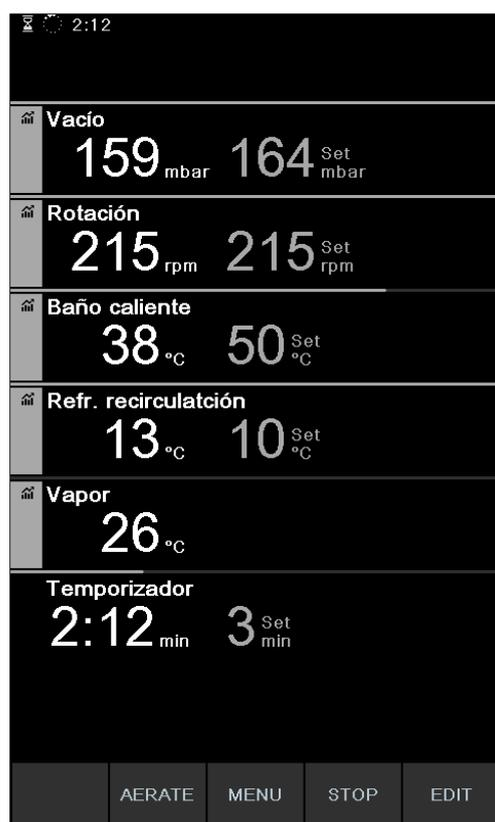
Fig. 33: Submenú "Temporizador" durante el proceso de destilación en marcha
