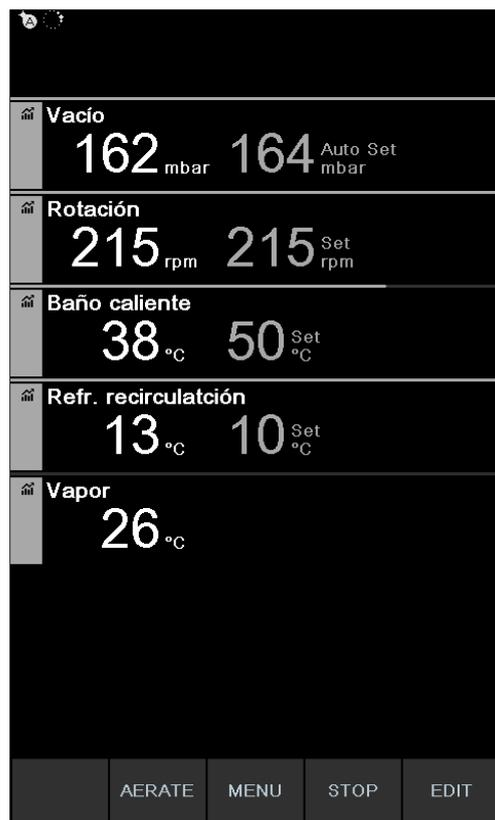
Fig. 42: Imagen de la pantalla durante la destilación automática
