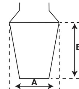
O par de números (por ex.: 29/32) descreve o tamanho da junta. O primeiro refere-se à largura da junta (A). O segundo (após a barra) refere-se ao comprimento da junta (B). Portanto, 29/32 significa que a junta possui 29 mm de largura e 32 mm de comprimento.
