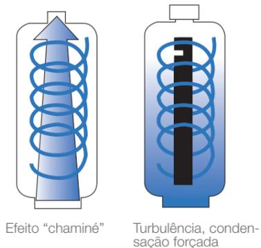
Por meio da evaporação (mudança do estado líquido para o gasoso), o volume da amostra aumenta 20.000 vezes. No condensador, o gás é recondensado para voltar ao estado líquido e o volume diminui imediatamente. Durante o processo de evaporação-condensação, a velocidade do vapor nas áreas mais estreitas da peça de vidro pode chegar a 150 km/h.
