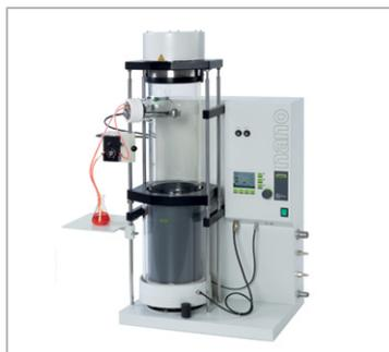
Der Nanosprühtrockner B-90 revolutioniert die heutigen Möglichkeiten der Sprühtrocknung. Er verfügt über die einzigartige Fähigkeit, für Probenmengen im Milligrammbereich bei hoher Ausbeute Partikelgrößen im Nanobereich zu erzeugen.
