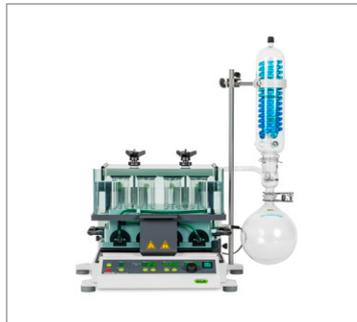
Mit dem Parallelverdampfer Syncore® Analyst können die Fraktionen, die mit Ihrem präparativen Chromatographiesystem gesammelt wurden, effizient und sicher verdampft werden.
