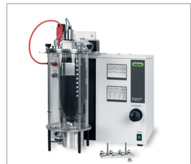
Verkapseln Sie mit Hilfe des Encapsulator B-390 oder B-395 Pro Ihre Wirkstoffe in einer Matrix, um sie zu schützen oder kontrolliert freizusetzen.
