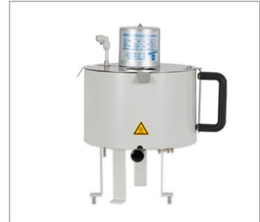
Le système d'atomisation par congélation (« Spray Chilling ») unique vous permet de travailler avec des échantillons fondus de cire ou de polymères avec un point de fusion pouvant aller jusqu'à 70 °C.
