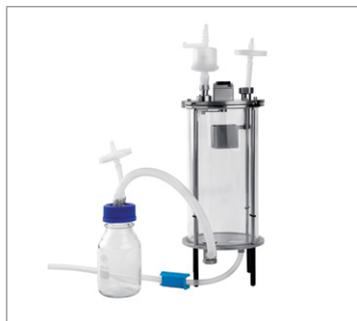
Reaction vessel untuk Encapsulator B-395 Pro benar-benar dapat diautoklaf sehingga memungkinkan pengkapsulan sampel secara steril.
