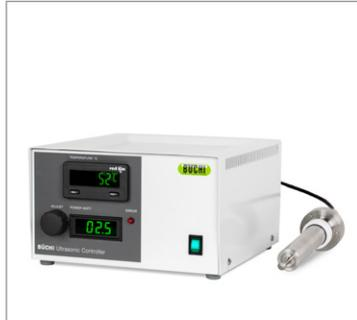
Perangkat ultrasonik membantu Mini Spray Dryer B-290 dalam menghasilkan partikel dengan kisaran ukuran dari 10 – 60  $\mu\text{m}$ . Dapat dikombinasikan dengan semua model Mini Spray Dryer B-290.
