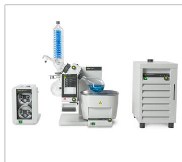
O Rotavapor® R-300 é uma solução completa em evaporação que permite a secagem de partículas sob vácuo previamente produzido pelo Encapsulador.
