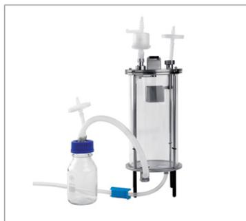
A câmara de reação para o Encapsulador B-395 Pro é totalmente autoclavável, o que permite a encapsulação estéril de amostras.
