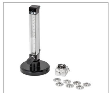
La boquilla de vibración de flujo permite la formación de perlas pequeñas (< 80 µm) y la producción de perlas con soluciones de alta viscosidad.
