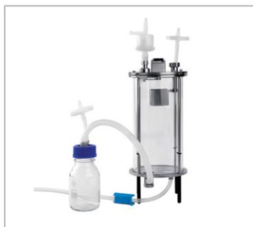
El recipiente de reacción para el Encapsulador B-395 Pro es totalmente esterilizable en autoclave, lo que permite la encapsulación estéril de las muestras.
