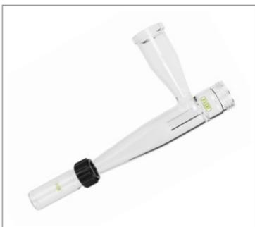
El ciclón de alto rendimiento está especialmente optimizado para recoger partículas pequeñas a gran rendimiento derivadas del Mini Secador por aspersión B-290.
