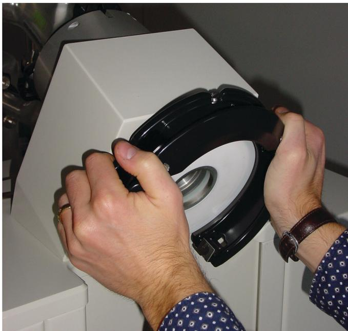
Figura 6.2: Montar la unión de cuello de matraz
