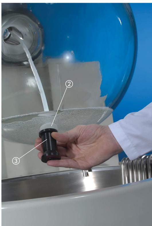
Figura 4.17: Posicionamiento de la punta del tubo con imán
