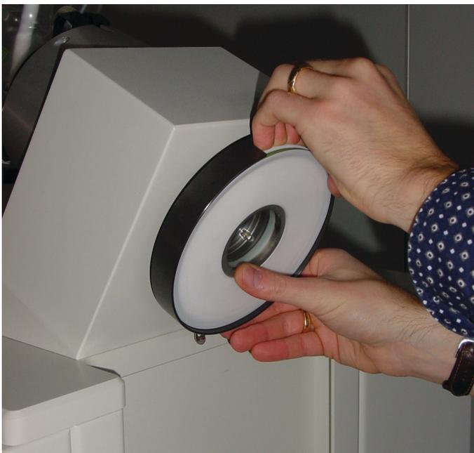
Figura 6.3: Quitar junta de matraz de evaporación
