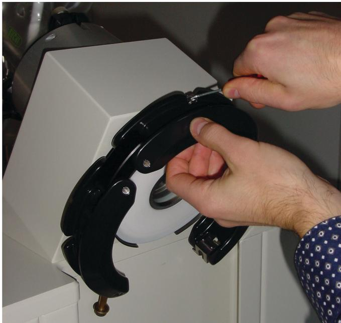
Figura 6.1: Desmontar la unión de cuello de matraz
