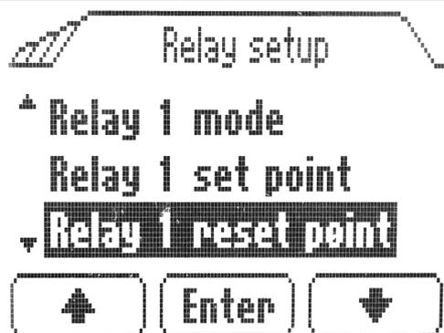
► Durch Drücken der Pfeiltasten **[Rücksetzwert Relais 1]** auswählen und den Wert für das obere Drucklimit einstellen.
