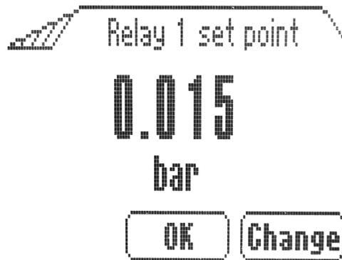
Es wird die Einstellung des aktuellen Vakuums angezeigt.
