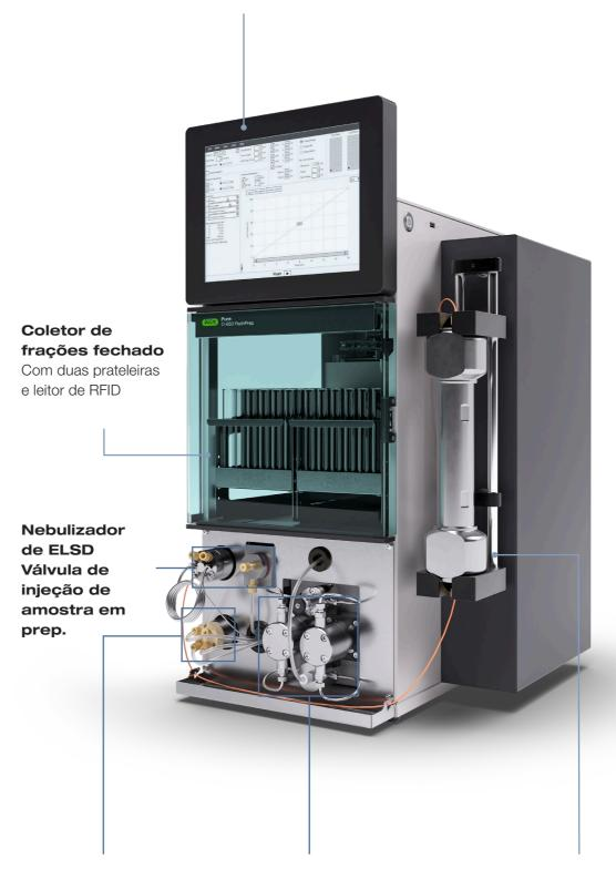
Separação de fluxo ELSD Bomba de HPLC prep. 300 bar, 100 mL/min 50 bar, 250 mL/min Suporte de coluna
