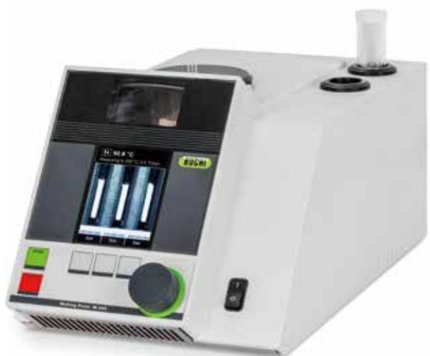
M-565はCCDカメラを装備し、融点および沸点を自動測定することで、高精度かつ効率的な品質管理が可能です。またサンプルローダーM-569と組み合わせて使用すれば、より再現性の高い測定ができます。
