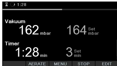
Abb. 33: Unterseite "Timer" während des laufenden Destillationsprozesses
