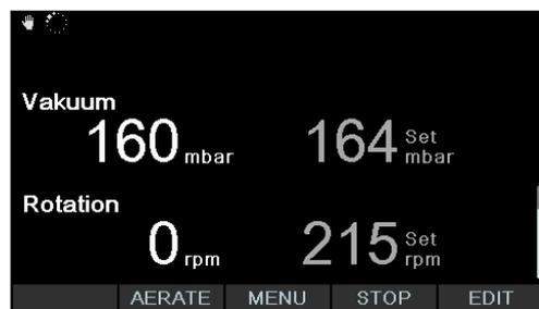
Abb. 29: Start des Destillationsprozesses
