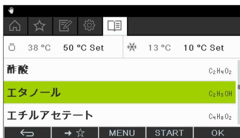
図 46: 溶媒データベースのサブメニューでの「エタノール」の選択
