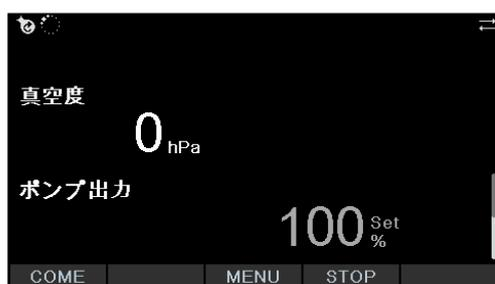
図 39: システムを乾燥させるための連続運転を開始した画面
