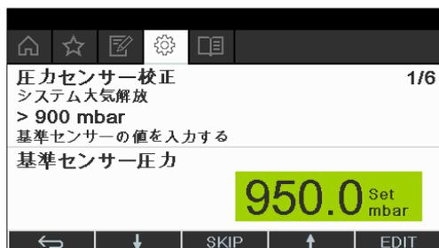
図 58: メニュー項目「圧力センサー校正」
