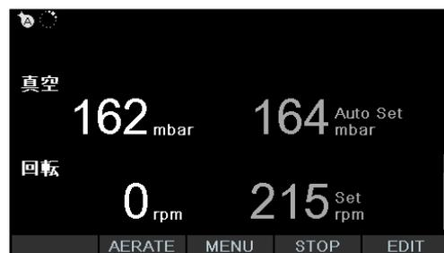
図 42: 自動蒸留進行中のディスプレイ表示
