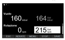
Fig. 30: Modifica dei parametri durante la distillazione
