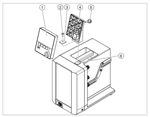
Fig. 10: Interfaccia sulla Pompa da Vuoto V-300
