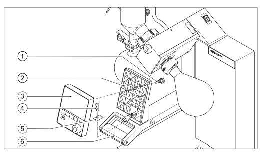
Fig. 9: Montare il supporto e l'interfaccia sulla maniglia
