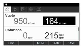
Fig. 22: Visualizzazione a colori invertiti del parametro modificato
