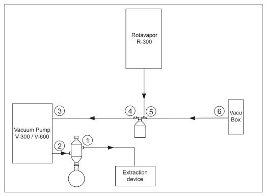
Fig. 16: Collegamenti dei tubi per il vuoto in un sistema di distillazione BUCHI
