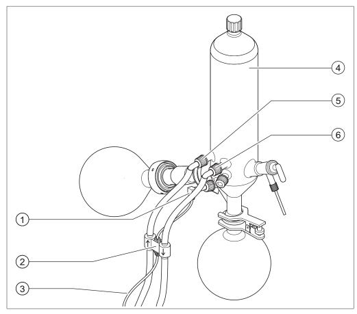
Fig. 17: Sonda AutoDest, sensore della temperatura del vapore e condensatore con pallone di evaporazione e pallone di raccolta di un Rotavapor® R-300
