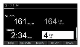
Fig. 34: Modifica dei parametri durante la distillazione
