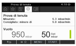
Fig. 54: Visualizzazione del tasso di perdita
