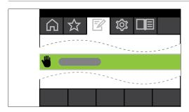
Fig. 27: Selezione della modalità [Manuale] nel menu Modalità operative
