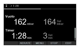
Fig. 33: Schermata "Timer" mentre è in corso il processo di distillazione
