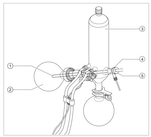
Fig. 18: Sensore di schiuma nell'unità di evaporazione di un Rotavapor R-300
