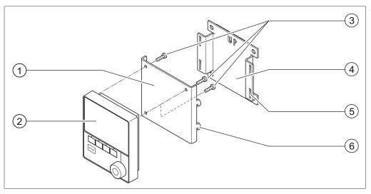
Fig. 12: Supporto a parete in due parti per l'interfaccia
