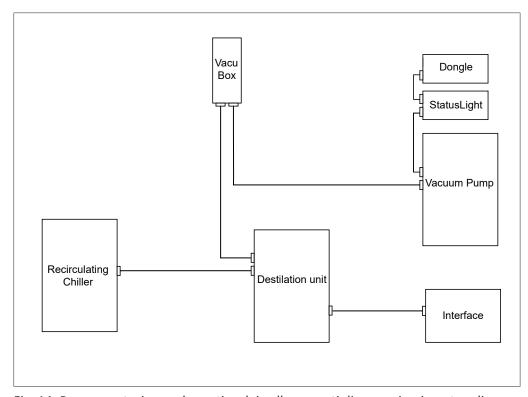
Fig. 14: Rappresentazione schematica dei collegamenti di comunicazione tra gli strumenti da laboratorio BUCHI (esempio)
