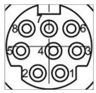
Fig. 5: Occupazione dei pin MiniDin 8 poli, vista sulla presa
