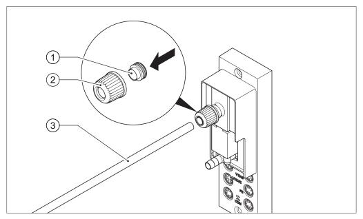
Fig. 55: Montaggio del dado di raccordo GL14 con guarnizione (esempio: VacuBox)
