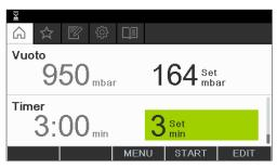
Fig. 32: Schermata iniziale [Timer] con il valore impostato per il timer evidenziato in verde
