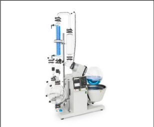
Rotavapor® R-220 Pro (เครื่องระเหยสารแบบหมุนระดับอุตสาหกรรม) ดำเนินการกลั่นสารปริมาณมาก ที่ด้วยปริมาตรขวดกลั่นสูงสุดที่ 20 ลิตร
