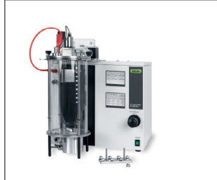
Encapsulator B-395 Pro (เครื่องผลิตเม็ดบีดและแคปซูล) การผลิตเม็ดบีดและแคปซูลของเซลล์สารชีวภาพ และสารออกฤทธิ์ที่ควบคุมได้สำหรับการวิจัยและพัฒนาในห้องปฏิบัติการที่ต้องอยู่ในสภาวะปลอดเชื้อ
