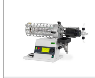
Glass Oven B-585 Kugelrohr (เครื่องกลั่นแยกแบบลำด้ยส่วน) สำหรับการกลั่น การระเหิด การทำแห้งแบบแช่เยือกแข็ง หรือการทำให้แห้งในตัวอย่างปริมาณน้อย
