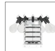
Acrylkammer mit 12er Verteiler oben und Regalfächern für das Trocknen von grossen Mengen in Gefässen und Kolben.
