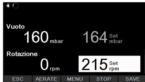
Fig. 30: Modifica dei parametri durante la distillazione
