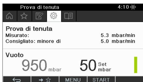
Fig. 54: Visualizzazione del tasso di perdita
