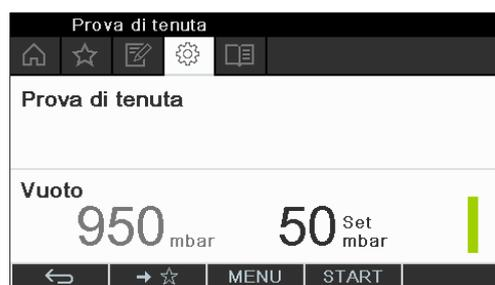
Fig. 53: Schermata per la prova di tenuta
