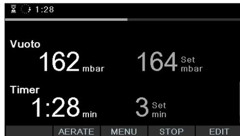
Fig. 33: Schermata "Timer" mentre è in corso il processo di distillazione
