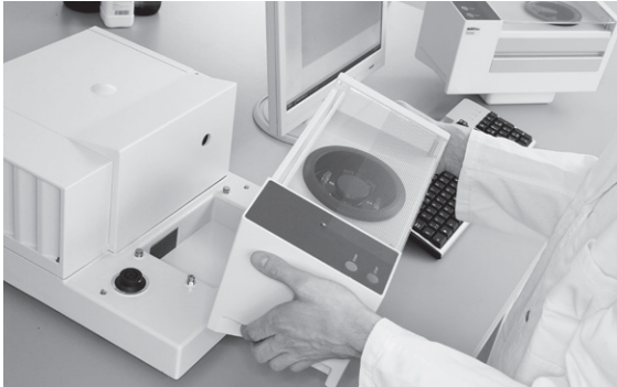
Installation einer Messzelle
