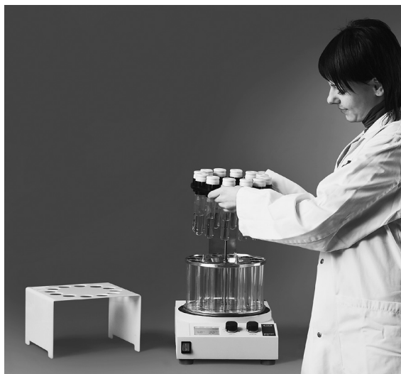
図4.12：トランスファープレートを利用したサンプルの同時移動
