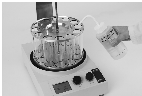
図6.1：運転中に十分な攪拌が得られる位置まで蒸留水を入れる。
