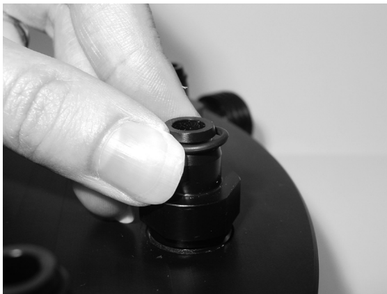
図7.2：コニカルアダプターのO-リングの交換
