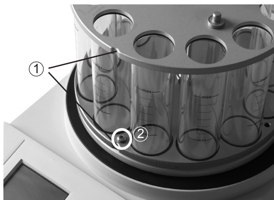
図5.1：クリスタルラックの加熱プレートへの取り付け
