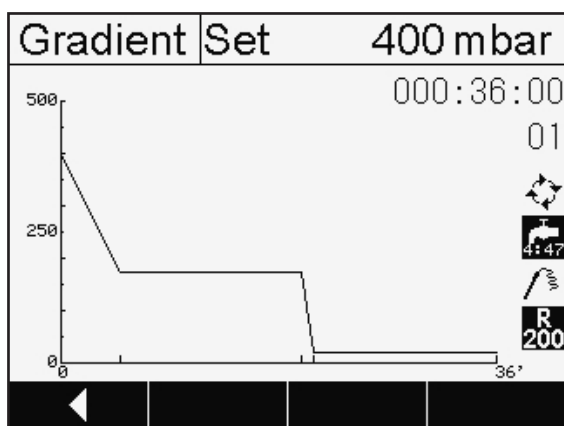
図6.5：溶媒蒸留後に乾燥ステップを加えた勾配設定の例
