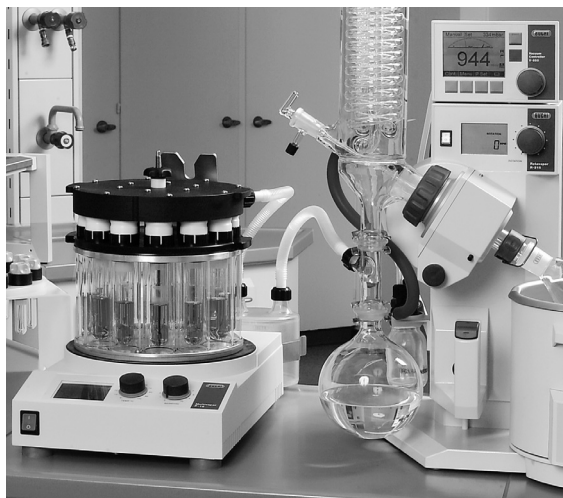
図4.16 : ロータリーエバポレーター設定に組み込まれたウルフ瓶
