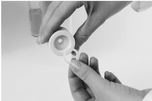
図7.1：ガラス試料管のシールの取りはずし
