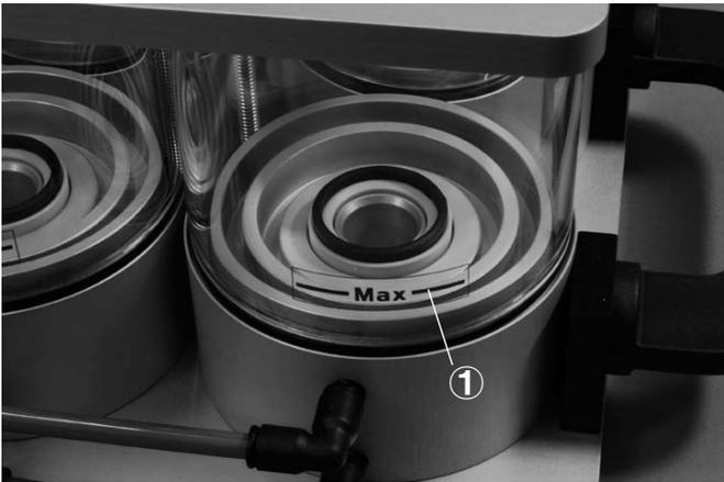
図21：残量冷却機能付き6本用ラック内の水
