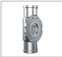
Фланцевая ячейка для молока Фланцевая ячейка X-Cell для молока — это дополнительное оборудование для установки датчика непосредственно в трубопровод. Типы ячеек для молока: DN 50, длина пути 1 – 15 мм, 10 бар Тип процесса: непрерывный и дискретный
