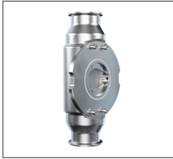
Ячейка (11061677) Ячейка X-Cell — это дополнительное оборудование для установки датчика непосредственно в трубопровод. DN 76, длина пути 92 мм, 20 бар Тип процесса: непрерывный и дискретный
