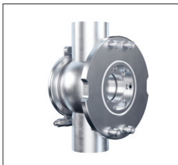
Адаптеры Varinline® Адаптеры Varinline® — это дополнительное оборудование для установки датчика непосредственно в трубопровод. Типы адаптеров Varinline®: DN 40 – DN 150, длина пути 1,5 – 10 мм, 10 бар Тип процесса: непрерывный, дискретный и серийный
