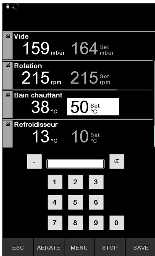
Fig. 30: Édition des paramètres au cours d'une distillation
