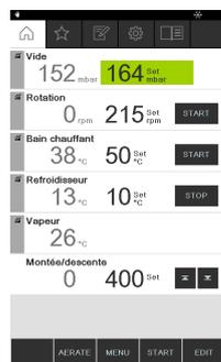
Les paramètres relatifs au processus de distillation en cours sont affichés sur la page d'accueil de l'Interface I-300 Pro. L'affichage des paramètres peut se présenter différemment selon l'interface à laquelle le Rotavapor est raccordé. Voici une comparaison des Rotavapors R-300 et R-220 Pro :
