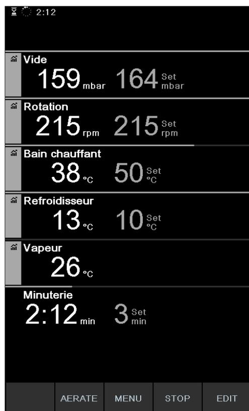
Fig. 33: Sous-menu "Minuterie" au cours d'un processus de distillation
