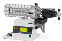
Glass Oven B-585 Kugelrohr (เครื่องกลั่นแยกแบบลำดับส่วน) สำหรับการกลั่น การระเหิด การทำแห้งแบบแช่เยือกแข็ง หรือการทำให้แห้งในตัวอย่างปริมาณน้อย
