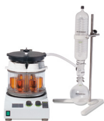
Multivapor P-6 / P-12 (병렬 증발 농축기) 독립형 Multivapor (병렬 증발 농축기)를 사용하면 맞춤형 시료 튜브를 완벽하게 통합할 수 있으며, 최대 12개 시료의 병렬 증발이 가능.
