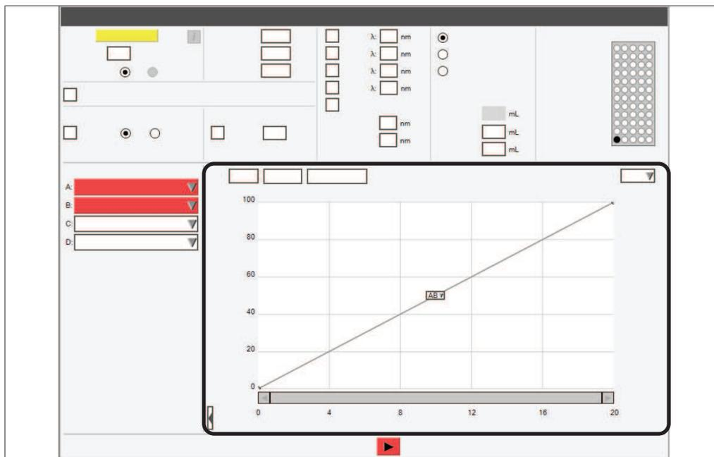
L'opzione Programma raccolta permette di interrompere la raccolta delle frazioni per un determinato periodo di tempo.
