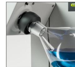
**Einfache Handhabung von Kolben mit Combi-Clip**
