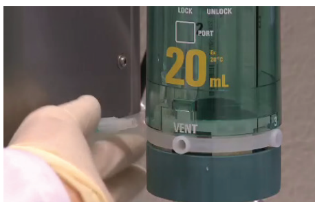
Fig. 5.8: Collegamento del tubo in FEP all'unità di dosaggio
