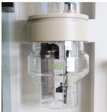
Fig. 5.17: Montaggio della rete protettiva sul sensore
