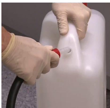
Fig. 5.7: Collegamento del tubo di scarico mediante raccordo diritto
