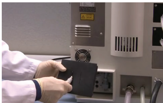
Fig. 5.10: Inserimento del cavo nella fessura
