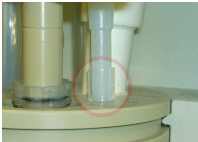
Fig. 5.12: Montaggio del distanziatore sulla punta di dosaggio
