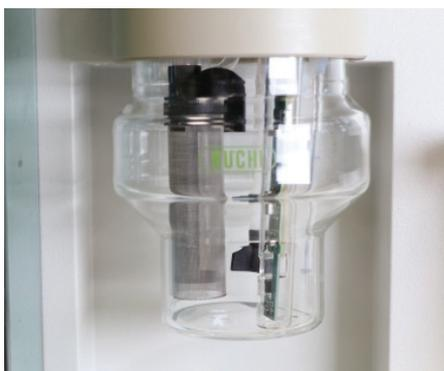
Fig. 5.17: Montaje de la malla de protección en el sensor
