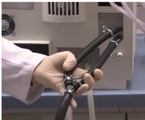
Fig. 5.6: Guía de las dos salidas en un solo tubo
