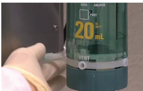
Fig. 5.8: Conexión del tubo FEP en la unidad de dosificación
