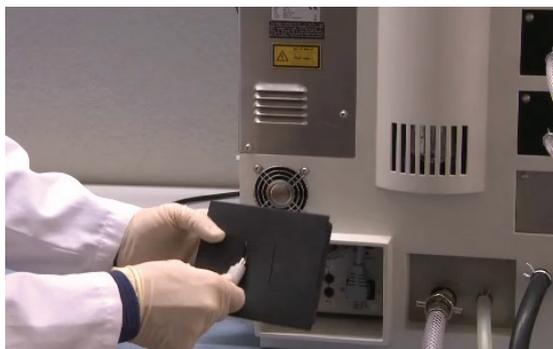
Fig. 5.10: Guía del cable a través del orificio
