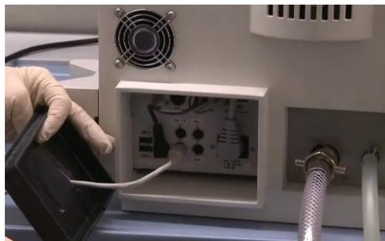
Fig. 5.11: Conexión del cable del motor de accionamiento
