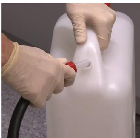
Fig. 5.7: Conexión del tubo de drenaje usando el conector recto
