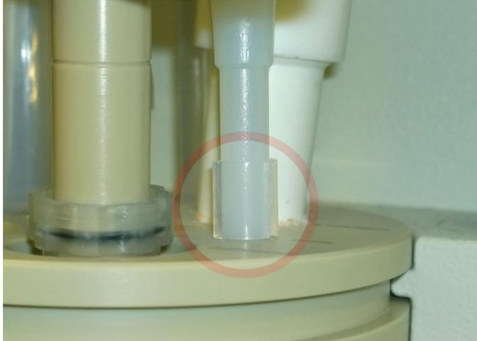
Fig. 5.12: Montaje del espaciador en la punta de dosificación
