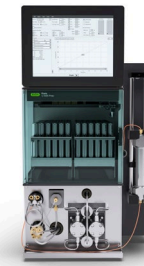
Pure C-830 (เครื่องแยกสารด้วยวิธีโครมาโตกราฟี)
